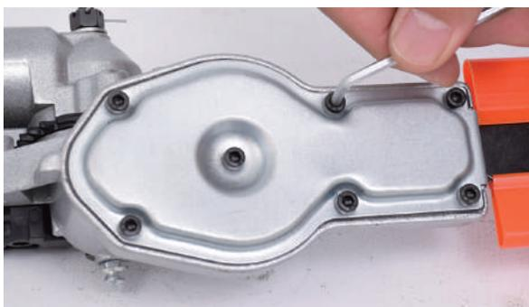
**3** ガasket付きプレートを外し、ロッドとフェルトパッキンを外します。
