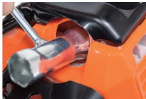
付属のプラグレンチで反時計回りで外します。振動等で緩まないよう少し固めに締付けています。
