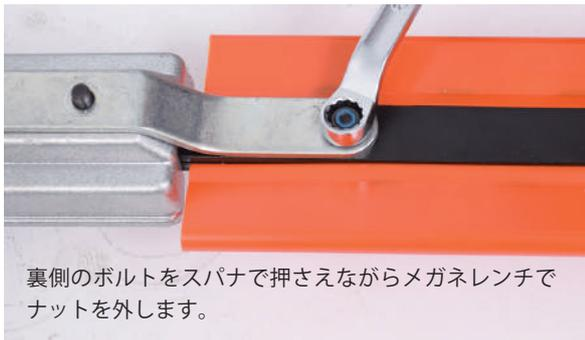
裏側のボルトをスパナで押さえながらメガネレンチでナットを外します。
