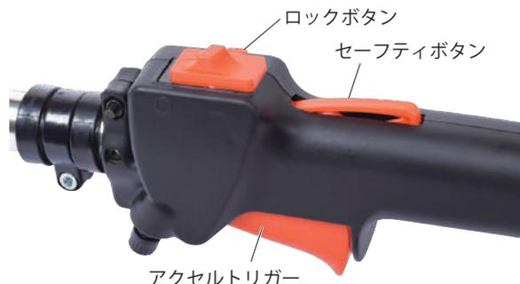
ロックボタンを押しながら、セーフティボタンとアクセルトリガーをゆっくり握っていくとロックボタンが押込まれ、アクセルトリガーがエンジン始動位置で固定されます。
