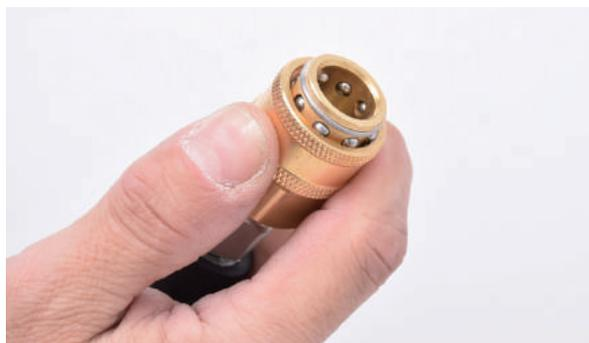
**2** ガンのジョイント（オス）を挿込みリングを戻します。
