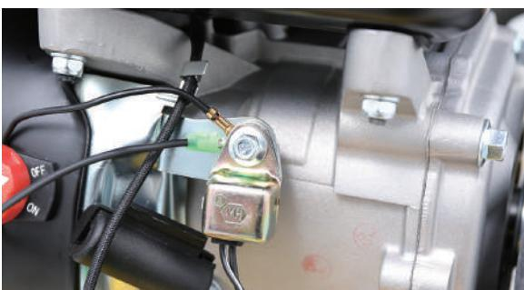
2 同じ位置に取付け、ボルトを締付けます。
