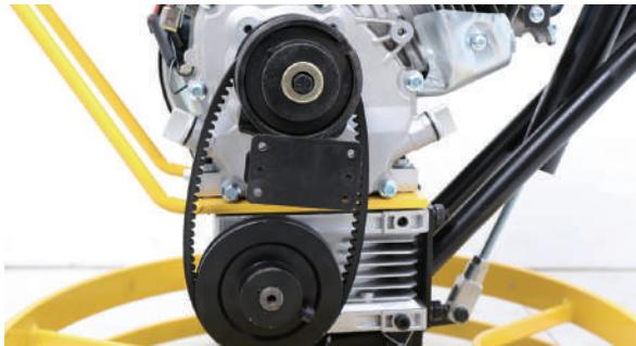
**3** ベルトがスリップし始めたら、クラッチの動作に異常がないことを確認し、ベルトの交換を行います。(詳細は P.26)
