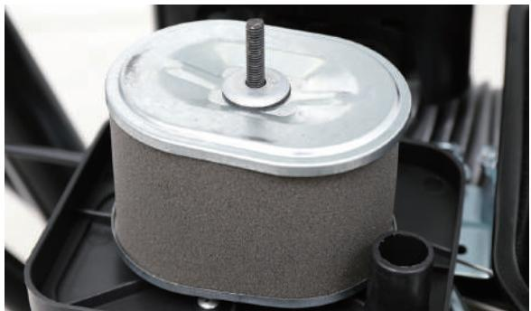
2 エアフィルタを取り外し、汚れをエアブロー等で吹き飛ばします。汚れがひどい場合は、中性洗剤入のぬるま湯で丁寧に洗い、よく乾燥させます。
