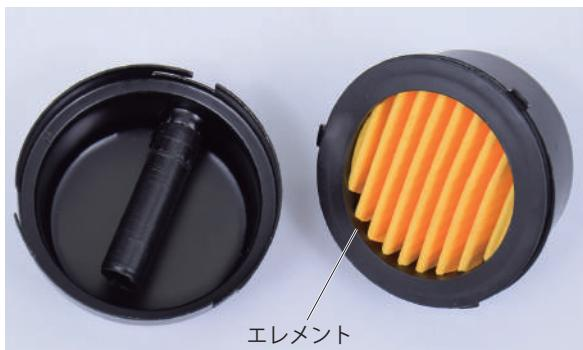
**3** エレメントの内側から圧縮空気を吹きつけて汚れを落とします。
