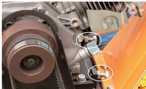
**2** ボルトを時計回りに回すとベルトの張りが強まります。両方のボルトを均一に回し、ベルトがプリー軸に対して直角になるように調整します。
