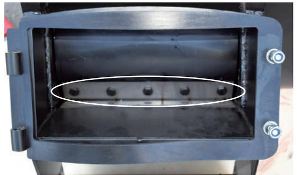
**2** ホッパーの底のブレード隙間調整板のボルトの緩みを確認し、緩んでいたら「必ず増し締め」をします。
