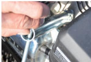
付属のプラグレンチで反時計回りで外します。振動等で緩まないよう少し固めに締め付けています。
