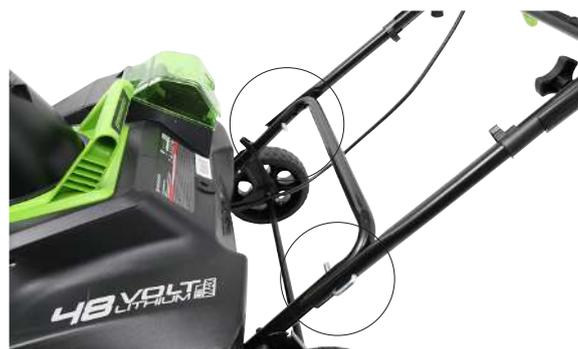
**3** ノブナットを取付け、軽く締めます。
