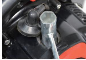
付属のプラグレンチで反時計回りで取外します。振動等で緩まないよう少し固めに締め付けています。
