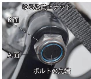
青いゴムのネジ山が滑り止めの役目をし、ゆるみにくくなります。写真のように最後までしっかりと締めてください。
