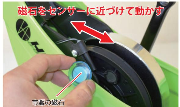
市販の磁石をセンサーに近づけて動かすることで、メーターの表示が変化します。作動しない場合は断線、もしくはメーターの異常が考えられます。
