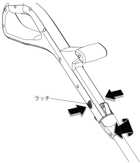
**3** 戻す時は左右のラッチを押しながら、トリマーヘッドを逆方向に180度回転させます。
