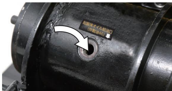
**9** ドレン口のすり切りまで給油します。オイルは完全に抜けきっていないので、規定量 0.11L より少なくなります。
