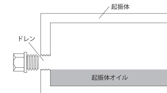
**10** ドレンボルト、起振体給油ボルトをしっかりと締めます。但し、締め過ぎには注意してください。強く締め過ぎると、ボルトの破損やパッキンが必要以上に潰れてしまい漏れの原因になります。
