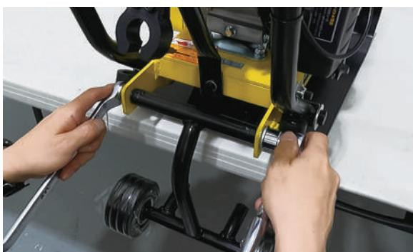
ローラーが動く程度にナットとボルトを締付けてください。
