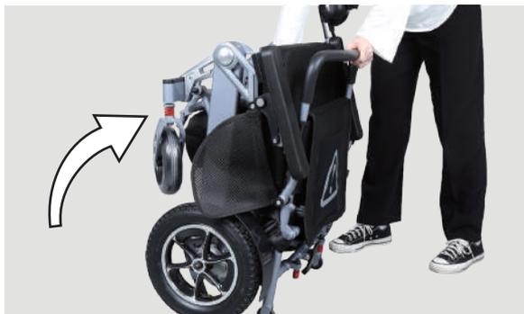
**3** 車いすのフレーム部分を両手で持って、立てた状態で積み込みます。揺れたり、周囲のものに当たったりしないように、緩衝材やベルトで固定します。
