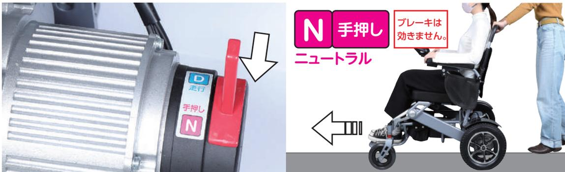
②クラッチレバーをD（走行）に切替えてジョイスティックを操作することで、電動モーターによる電動走行ができます。停車中は常に電磁ブレーキが効くため、手押し走行はできません。
