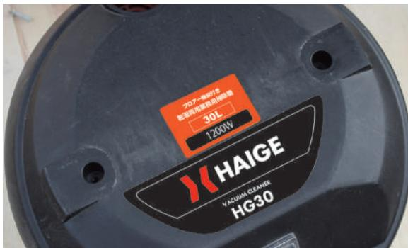
6 ネジ4カ所を取外し、カゴを取外すとモーター部分が露出します。
